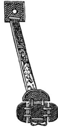
Abb.2. Schlitzvisier nach TYCHO, bestehend aus zwei gleichen rechteckigen Platten. Anvisieren eines Sterns geschieht z. B. durch den linken Schlitz der augennahen Platte am linken Rand der zweiten Platte entlang.
